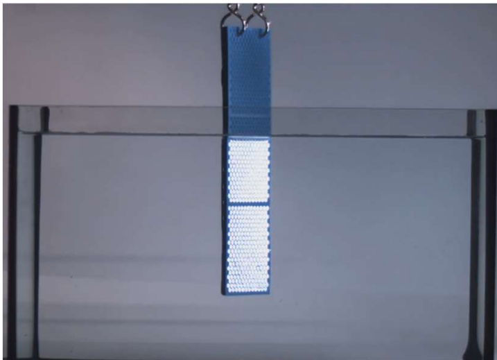
Abb. 2: Totalreflexion an der Luftschicht einer eingetauchten Polymerprobe
